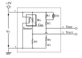
Vc : 回路电压 Vout: 输出电压 VREF: 参比电压
