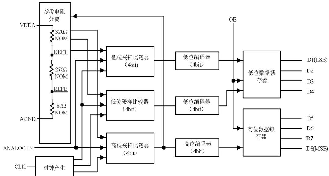
输入/输出结构示意图
